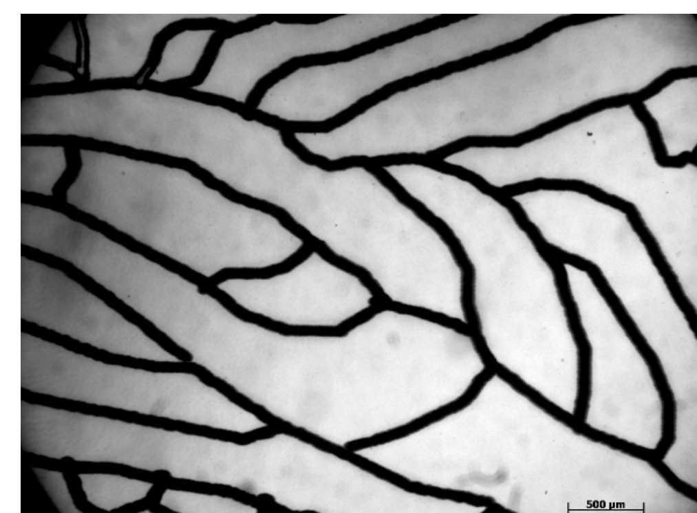
Rys. 4. Struktura mikrokanalów po wprowadzeniu korekty do projektu, na skutek obserwowanych nieciągłości struktury.
